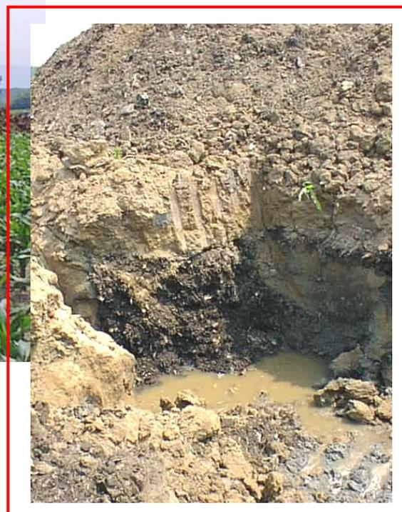
Veduta dell'area di indagine e, nel riquadro, particolare di una delle trincee scavate con in evidenza i rifiuti costituiti da *fluff* e la quota dell'acquifero.
