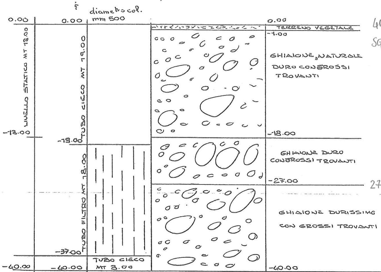
PERFORAZIONE  $\varnothing$  800 da P.C. a 12.00 mt di profondità
